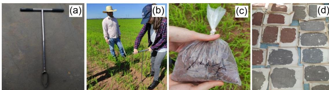
**Figura 3.** Trado do tipo holandês (a), coleta (b), amostra identificada (c), amostras secas ao ar (d).
